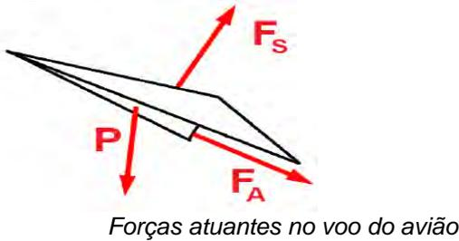
A força de sustentação, por sua vez, é dada pela equação (1), onde a aceleração vertical é dada pela equação (2).
