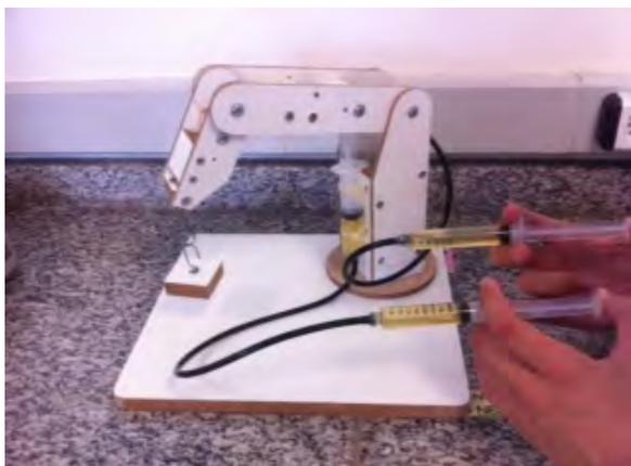
**Figura 2:** Imagem ilustrativa do braço hidráulico sendo movimentado pelo óleo de mamona.
