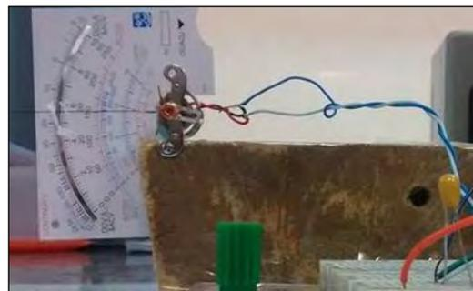
**Figura 1.** Galvanômetro e escala
