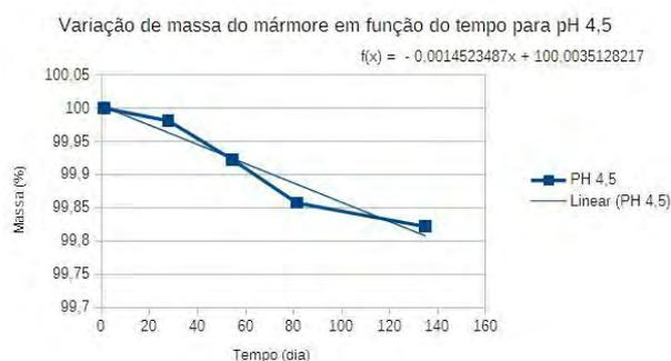
**Figura 2:** Gráfico da variação de massa do mármore em função do tempo para o pH 4,5
