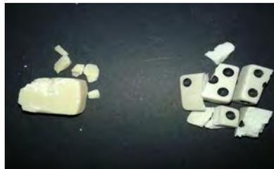
**Figura 1:** Amostras após o teste de resistência de 91,5 cm. Galalite (esquerda) e PS (direita).
