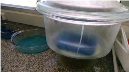
**Figura 3:** Bioplástico secando no dissecador.
