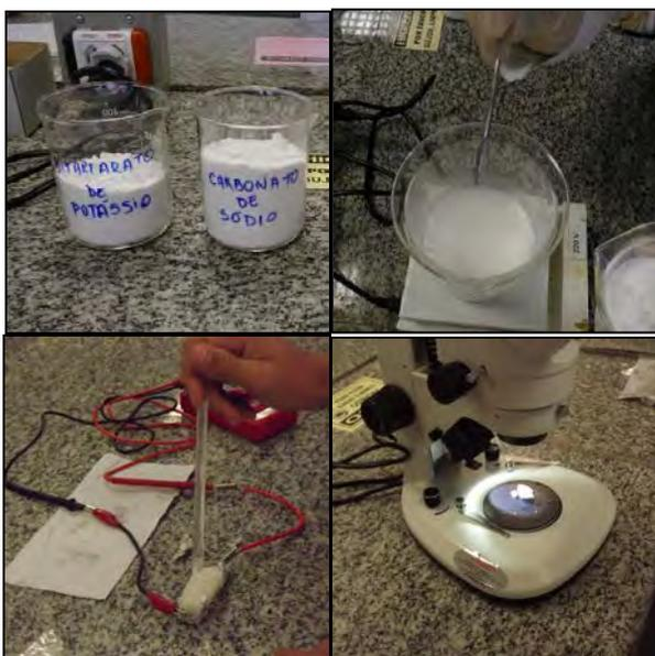
Figura 1: (a) Reagentes para formação do cristal. (b) Procedimento para formação dos cristais. (c) Análise da propriedade piezoelétrica mediante multímetro. (d) Análise morfológica dos cristais.
