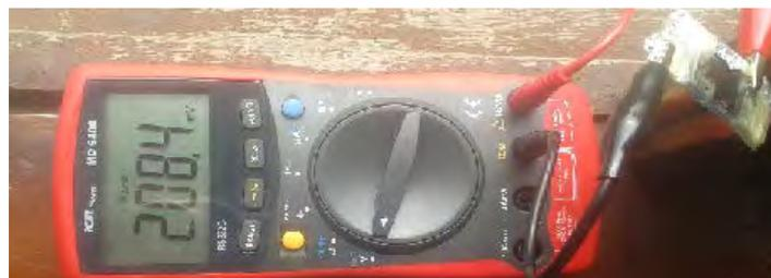
Figura 1 - Medição da Fotocélula à base de Clorofila
