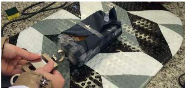
**Figura 1:** Imagem ilustrativa da mensuração da força de atrito, utilizando um dinamômetro eletrônico.
