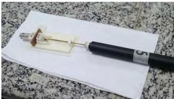
**Figura 1:** Dinamômetro para medição do isolamento magnético
