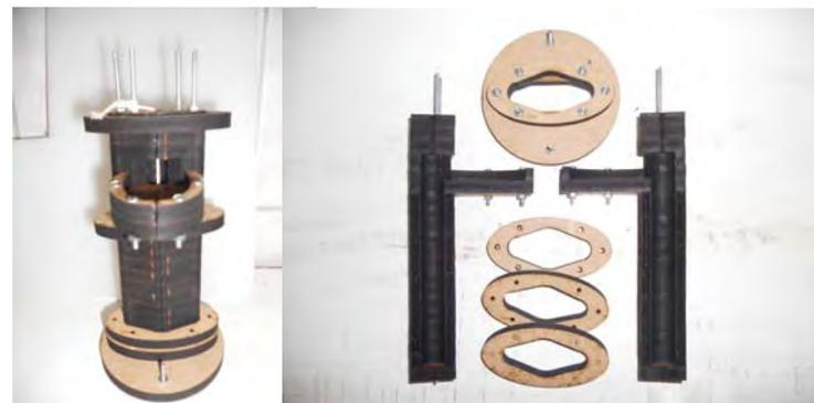
**Figura 1:** Ilustração do molde usado para confeccionar as velas.
