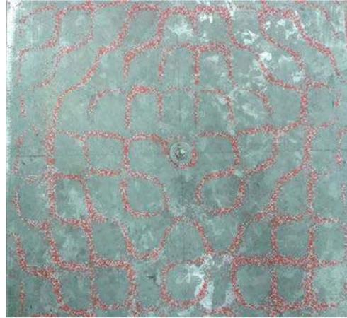
Figura 2 – Padrão formado a 1657,4Hz
