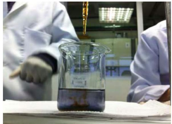
**Figura 1:** iodato reagindo com solução de amido e ácido ascórbico
