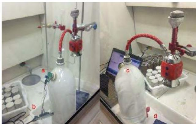
Figura 1: Dispositivo durante condução do experimento com narguilé na capela. a) Adaptação para o Sensor MQ135. b) Arduino Uno. c) Adaptação para o narguilé. d) Tampa inferior por onde flui a água.
