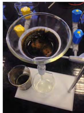
**Figura 1:** resultado final da eletrofloculação
