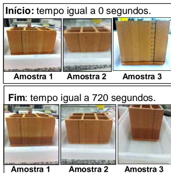
Figura 1 – Situação dos tijolos no início e no término do experimento conforme amostra.
