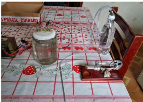
Figura I: Fonte, cuba eletrolítica, borbulhador e motor Stirling.
