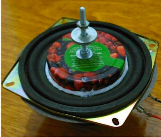
Figura 1 – Alto-falante com a tampa e o parafuso colados.
