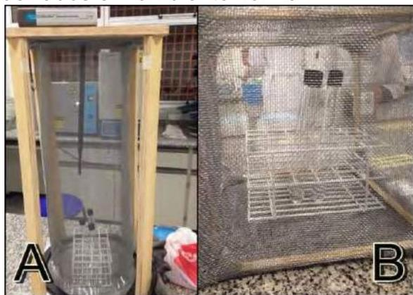
**Figura 1:** A: Tubos sob superexposição; B tubos na gaiola de Faraday.
