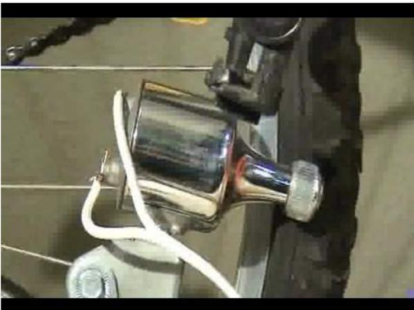
**Figura 2.** Fixação do dínamo na Roda
