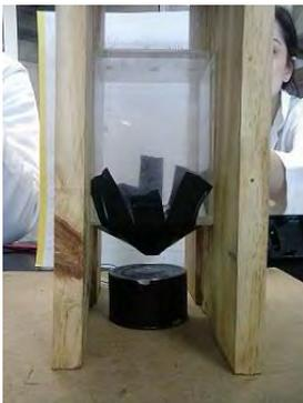
**Figura 2:** elevador suspenso por eletromagnetismo
